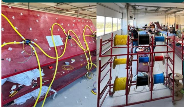
1. Estação de chicote elétrico
