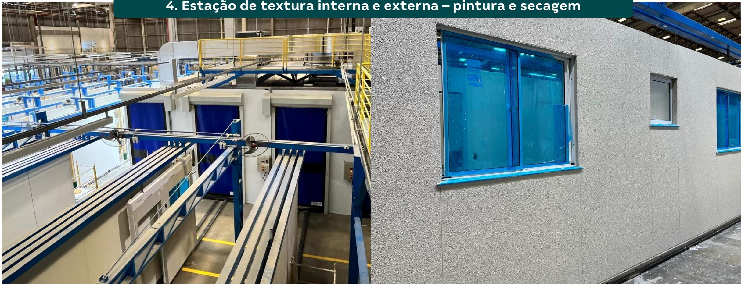
Destaque também para **nova linha de platibanda**, que permitirá a **montagem, aplicação de textura e secagem no mesmo takt** da linha principal de painéis
